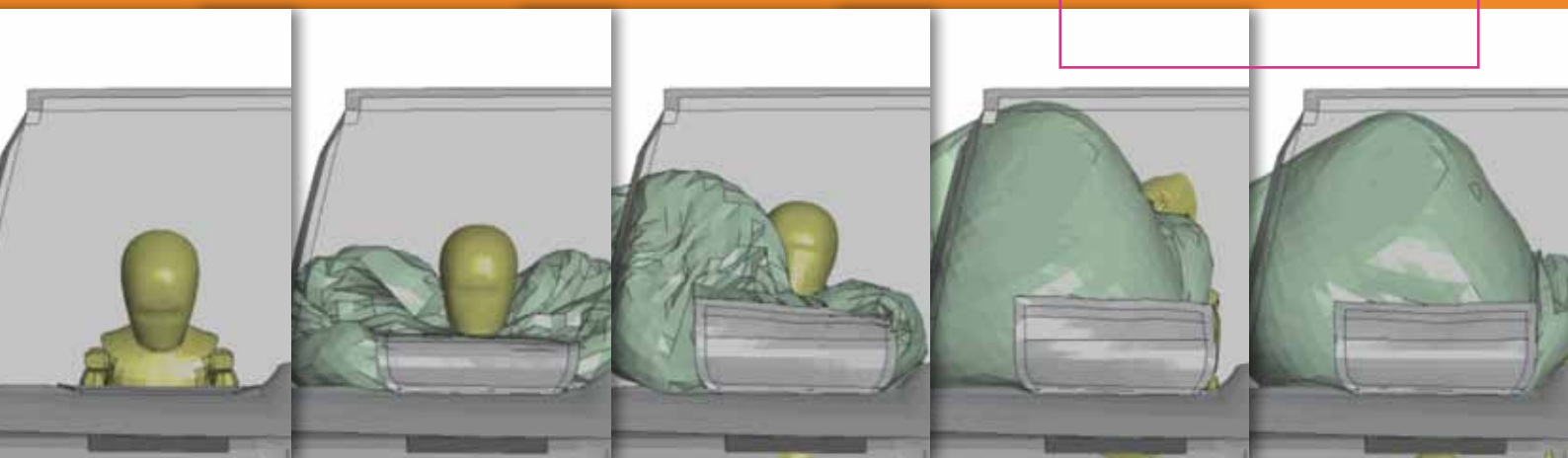
Casser une auto pour gonfler un airbag, c'est évidemment très coûteux, surtout s'il faut recommencer plusieurs fois pour tester différentes solutions... alors qu'une modélisation mathématique permet de multiplier les tests à moindre coût.
